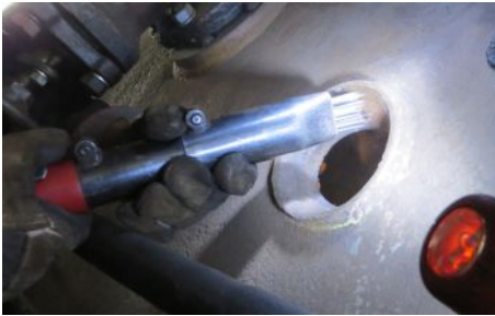
Nadeln des Waschlukenfutters mit dem Druckluftnadel
